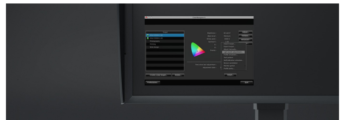
Der ColorNavigator speichert die Kalibrierung direkt in der in Look-Up-Table des Monitors.
